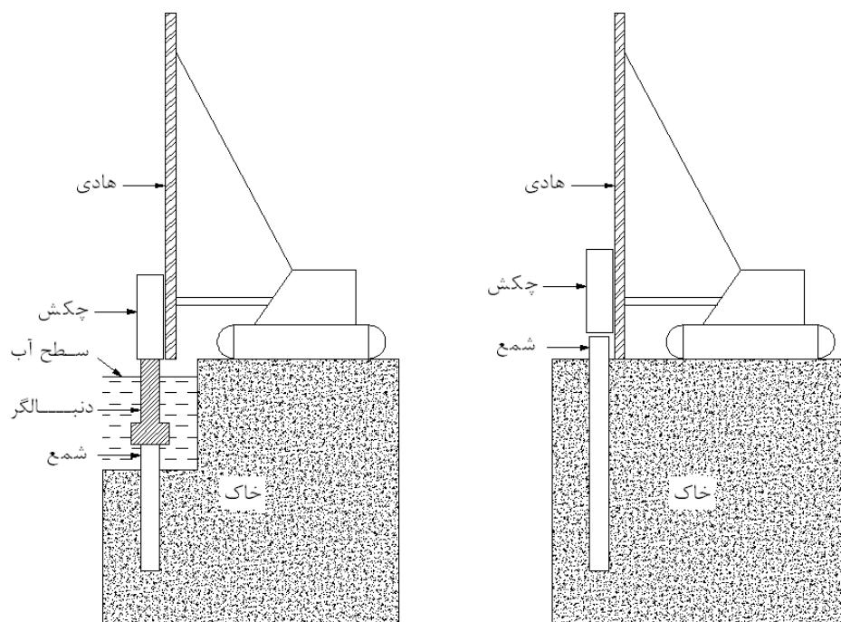
شکل ۲-۴- تصویر شماتیک هادی و دنبالگر
