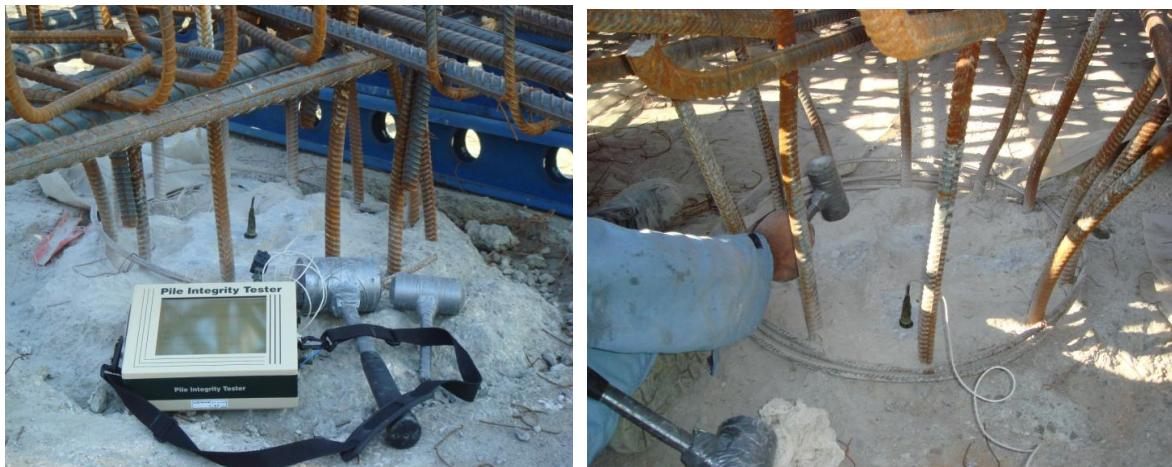
شكل الف-۱۸- تجهیزات تست کنترل یکپارچگی شمع PIT
