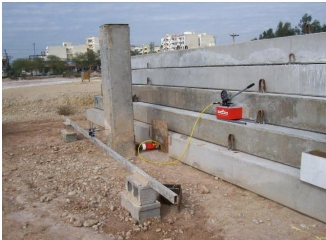
شکل الف-۲۲- تست بارگذاری استاتیکی جانبی
