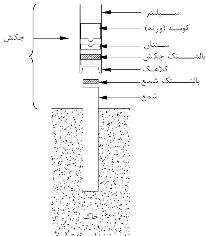
شکل ۴-۱- تصویر شماتیک شمع و تجهیزات کوبش
