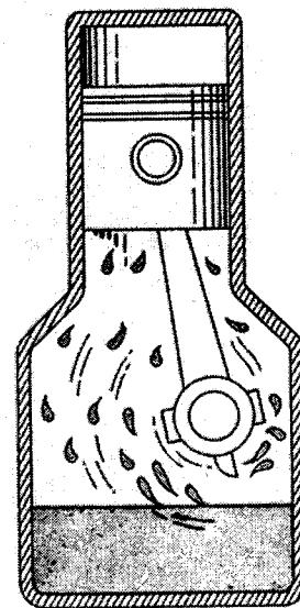
شكل ۲-۱۴ سیستم روغنکاری پاشش
