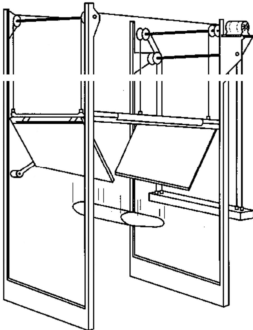
شکل ۱- شماتی دستگاه آزمون سقوط آزاد
