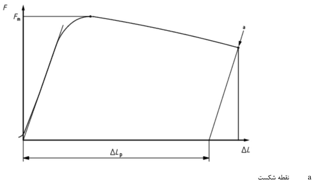
شکل ۳- منحنی بار-تغییرمکان برای تعیین افزایش طول پس از شکست،  $A_f$
