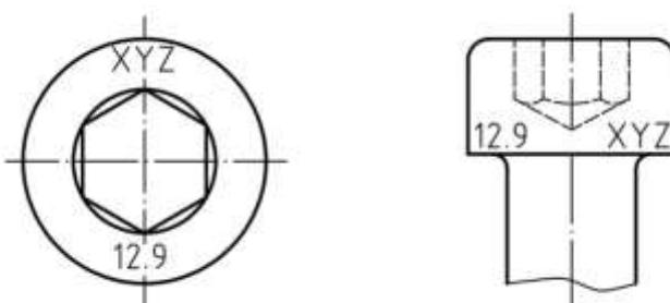
شکل ۱۲- نمونه هایی از نشانه گذاری بر روی آلن شش گوش
