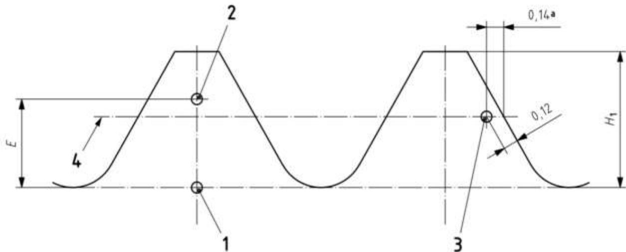
$HV(2) \geq HV(1) - 30$  که دکربوره نشده هنگامی که
