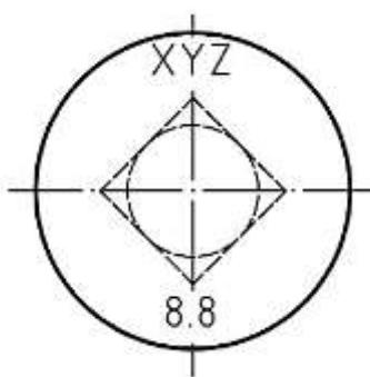
شکل ۱۳- نمونه‌ایی از نشانه‌گذاری بر روی پیچ‌های ااطاقی
