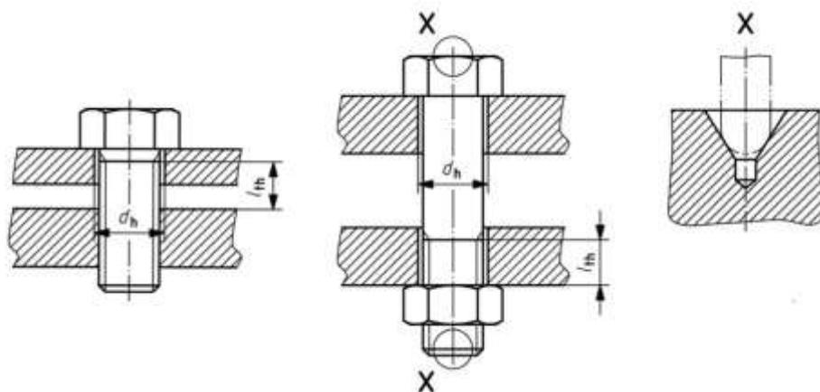
الف- نمونه‌ای از وسیله آزمون برای پیچ‌های مهره خور پیچ‌ها
